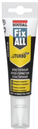
Очень быстрый клей-герметик на основе гибридных полимеров SMX. Фиксация в течение 20 минут. Возможна регулировка в течение 5 минут. Окончательная прочность достигается после 3 часов. Характеризуется отличной адгезией ко всем строительным материалам. Клеит также влажные материалы.
