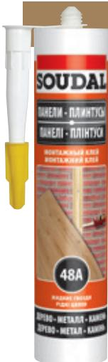
Водостойкий клей на основе синтетического каучука. Содержит растворители. Обладает высокой силой соединения и отличной адгезией к различного вида строительным материалам, за исключением полипропилена (ПП) и полиэтилена (ПЭ). Заменяет гвозди и шурупы. Не использовать с пенопластом.
